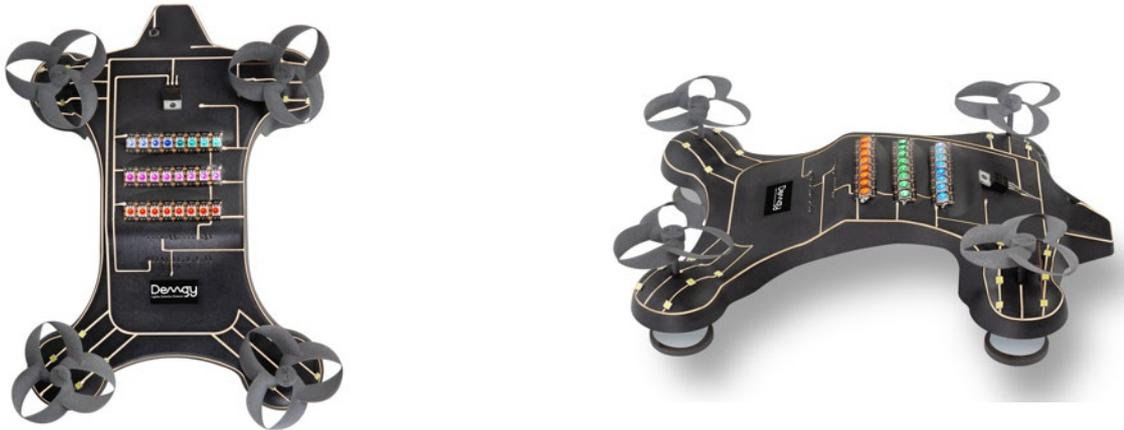
©DEMGY – Exemple de démonstrateur réalisé en fabrication additive avec ajout de métallisation sélective pour apporter une conductivité électrique
